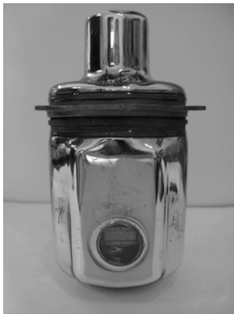
Рис. 4. Фото стеклянных дуаров, охлаждаемых жидким азотом с фоторезисторами из InSb (1961 г.)
